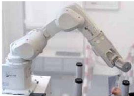
↑ Bild 1: Perfekte Forschungsgrundlage. Der Knickarm-Roboter hat sechs Achsen am Arm, erlaubt komplexe Bewegungsabläufe bei bis zu 12 kg Tragkraft und versorgt zusätzliche Achsen im Werkzeugkopf
