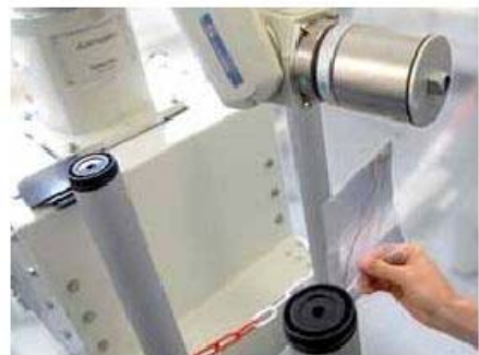
↑ Bild 2: Ein starker Magnet am Roboterarm bewegt die Kamerakapsel in der Plastiküte. Die Tüte simuliert das umgebende Gewebe. Die Stromversorgung ist hier kabelgebunden, um auch längere Testreihen zu ermöglichen
